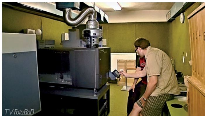
První digitální projekce. Lukáš Pártl spouští digitální 4K promítačku SONY SRX-R320. V popředí a pozadí jsou klasické 35 mm promítačky Mopta, které jsou stále plně funkční.
